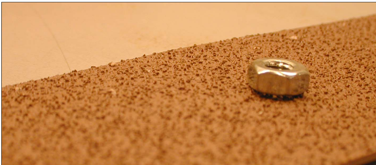
Figur 5 Permagrit verktøy bestående av metallplate med påsprøytet WC-korn. Kornstørrelsen betegnes som "coarse".
