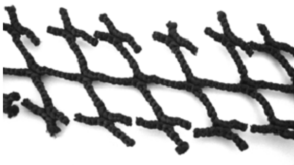
Figur 8 Form på prøve brukt i styrketest.
